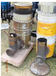
空き缶を使ったロケットストーブ、薪で料理する。
