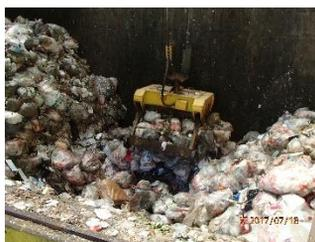
袋に入れられた可燃物がここに投入されクレーンでボイラーで焼却される。2個のボイラーが稼働中。
