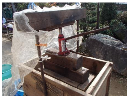
もろみを袋に入れて圧搾機にかける。上からジャッキで締め付ける。虫や異物が入らないように紗が掛けられている。一滴一滴と絞れ醤油がしたたり落ちる。
