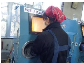
砂を吹き付ける装置になか作業の様子
